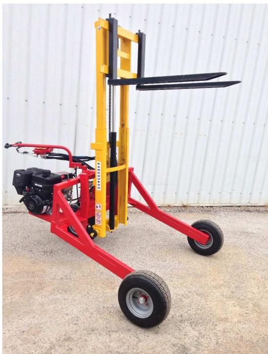
Ce transpalette gerbeur 1roue motrice permet de transporter des charges de 700 kg sur des terrains variés. Il trouve son utilité en agriculture et dans tous les domaines où un appareil léger et tout terrain est nécessaire
